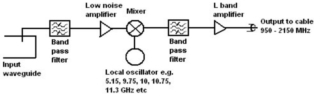
Figure 2: LNB diagram
