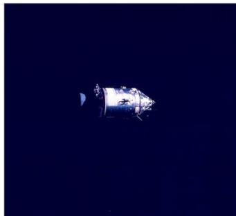
Fig. 5 Command Module (CM)
